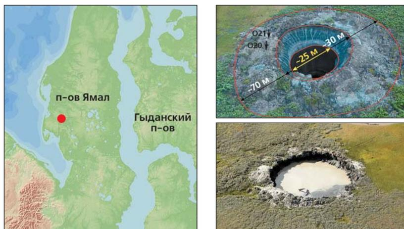
Рис.6. Ямальская воронка газового выброса. Слева — ее положение на карте, справа сверху — вид с вертолета 16 июля 2014 г. и размеры кратера, внизу — вид с вертолета 31 августа 2015 г.
