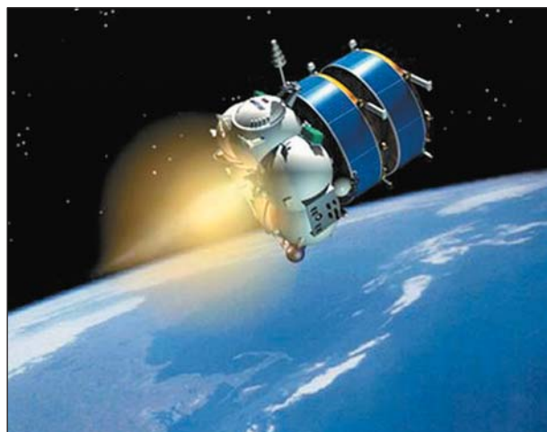
Рис.4. Заключительная стадия полета модуля Фрегат: выведение очередной пары спутников «Cluster» на рассчитанную орбиту.
