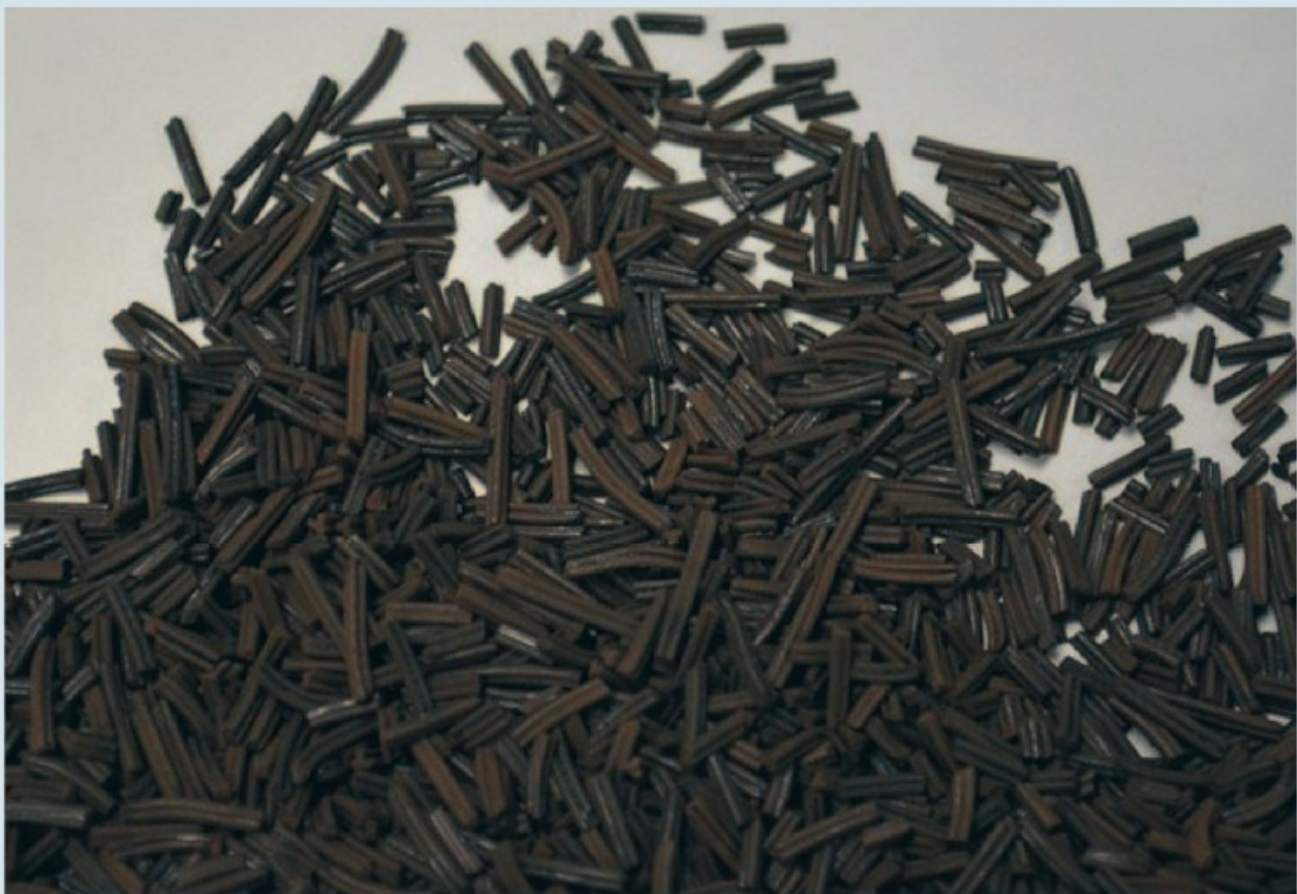
Рис. 20. Внешний вид трехкомпонентного катализатора гидроочистки вакуумного газойля
