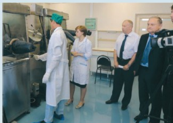
Проведение испытаний системы перчаточных боксов с контролируемой инертной атмосферой для сборки ЛИА
