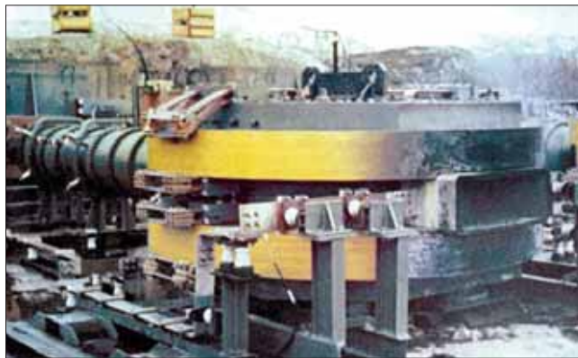
МГД-установка «Хибины» для изучения земной коры на Кольском полуострове.
