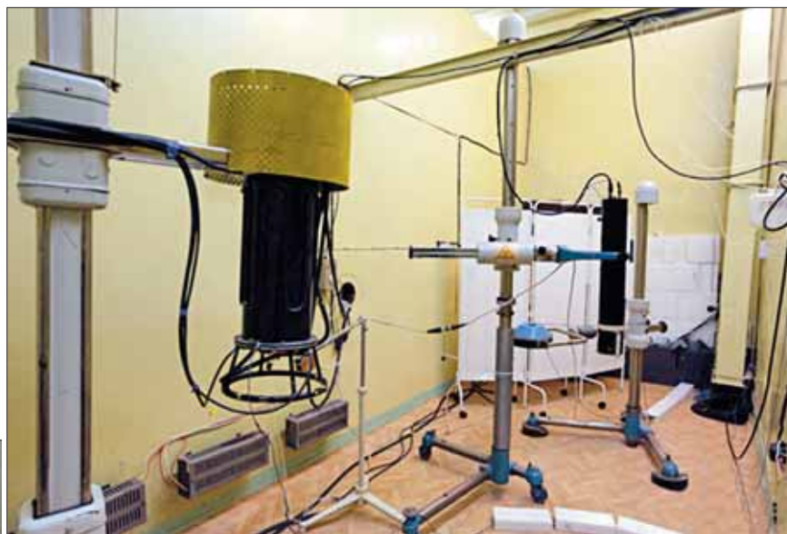
Компактный генератор нейтронов НГ-24 для медицинских целей.
