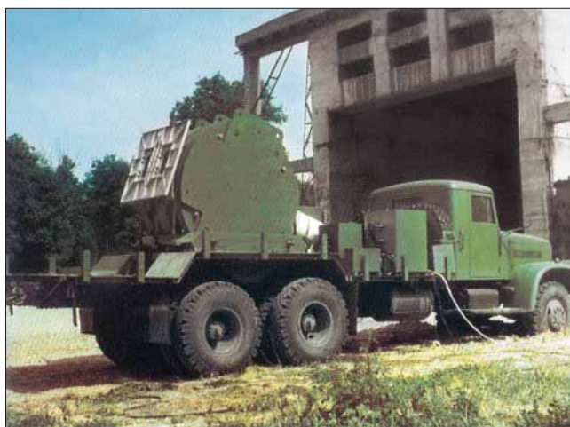
Установка «Прикаспийский» для электроразведочных работ с целью обнаружения нефтяных месторождений.
