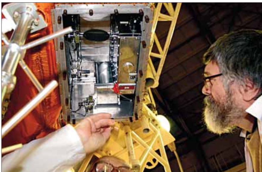
Заключительная операция перед запуском спутника «Коронас-Фотон» 30 января 2009 г.: снятие защитных крышек на телескопе и установка термозэкрана.
