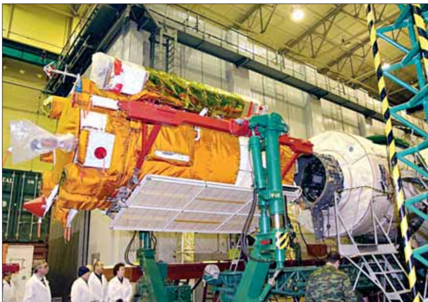
Спутник «Коронас-Фотон», пристыкованный к ракете, перед запуском на космодроме Плесецк.
