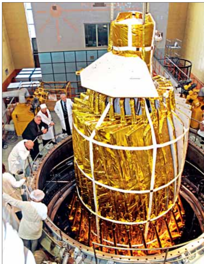
Электрические испытания полностью собранного и укомплектованного штатными образцами бортовой аппаратуры космического аппарата «Радиоастрон» в Научно-производственном объединении им. С.А. Лавочкина.
