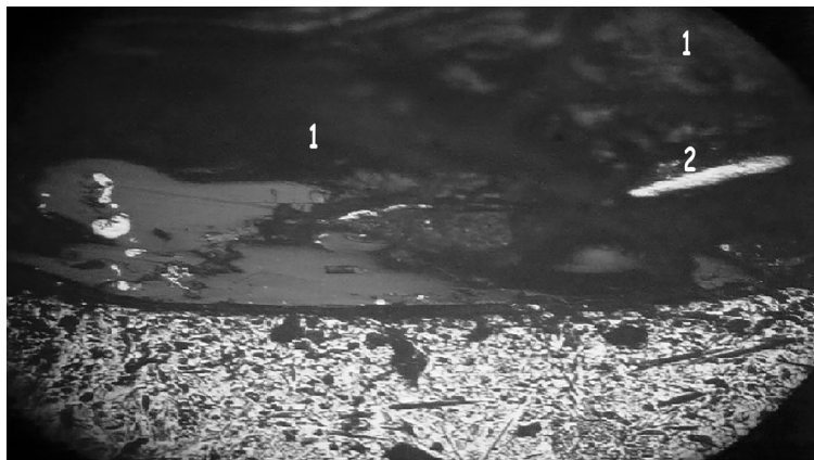
Рисунок 1.3 – Закристаллизовавшиеся частицы расплава (1) в шлаке (2)
