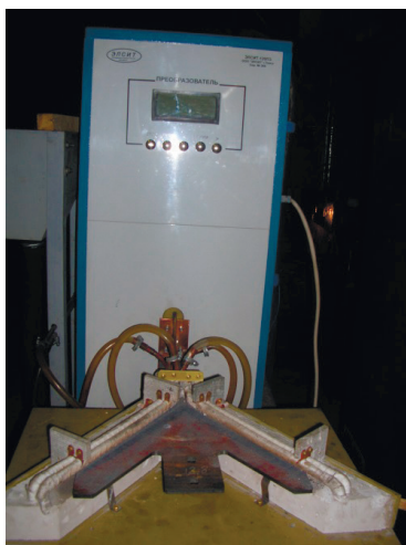
Рисунок 7.4 – Стрелчатая лапа «АЛТАЙ», помещенная в индуктор с разными составами компонентов наплавочной шихты
