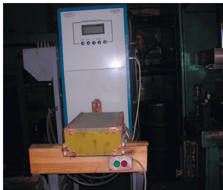
Рисунок 7.3 – Индуктор для индукционной наплавки молотков кормодрилоков, подключенный к высокочастотному генератору «ЭЛИСТ 120 ПЗ»
