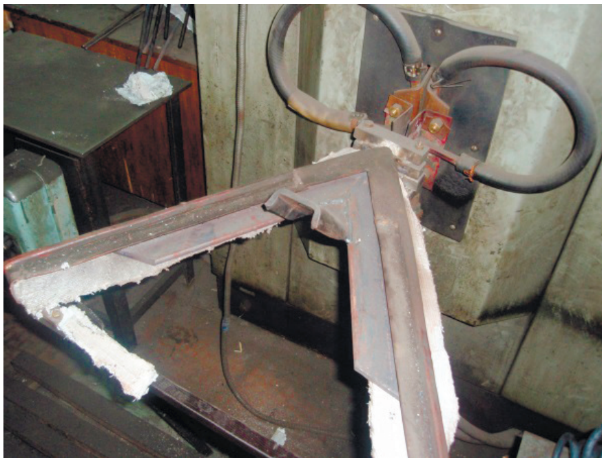
Рисунок 7.1 – Индуктор, подключенный к ламповому генератору ВЧГ 3 160/0,066 для наплавки стрелчатых лап различных типоразмеров
