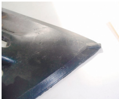
Рисунок 4.21– Штампованная стрелчатая лапа с усиленным носком зарубежных фирм
