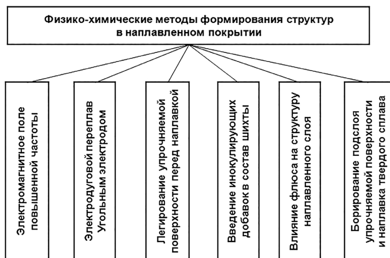
Рисунок 4.10 – Методы физико-химического и технологического воздействия на формирование износостойкого слоя в процессе индукционной наплавки
