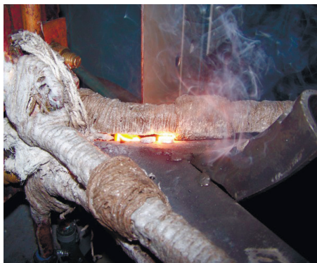
Рисунок 7.2 – Термоиндикаторы, регистрирующие температуру поверхности детали при температурах 750 К и 1250 К (начала плавления флюса и наплавляемого сплава)
