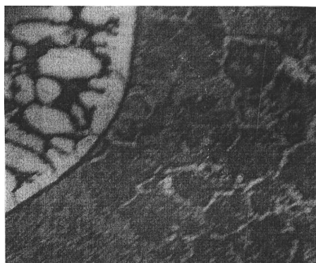
Рисунок 4.27 – Участки образования общих зерен хромистого чугуна марки смеси ПГ-14-60 и низколегированной стали Св08ГС (x500): общее зерно разных металлов: чугун (1) сталь (2)
