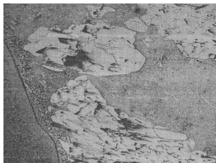
Рисунок 4.31 – Микроструктура наплавленного сплава ПС-14-60 в разделку кромок сталь 65Г (x300)
