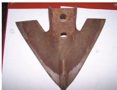
Рисунок 4.24 – Стрелчатая лапа с рифленым профилем носовой части
