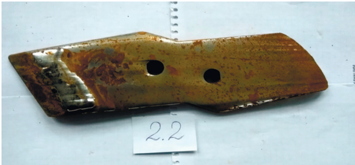
Рисунок 6.13 – Долото с наплавленной режуще-лезвийной частью после наработки 5 га и схема измерения износов (наружная, рабочая поверхность)
