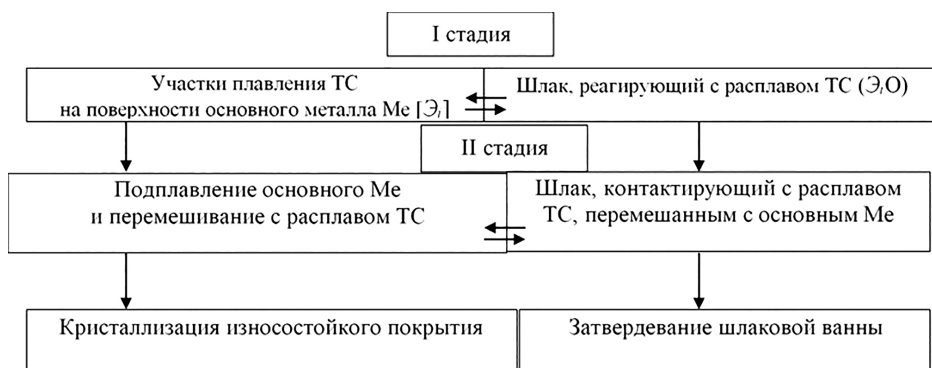
Рисунок 1.2 – Блок-схема взаимодействия фаз при индукционной наплавке
