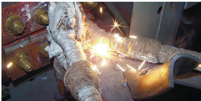
Рисунок 3.12 – Воспламенение термоиндикатора на поверхности детали, нагреваемой токами высокой частоты
