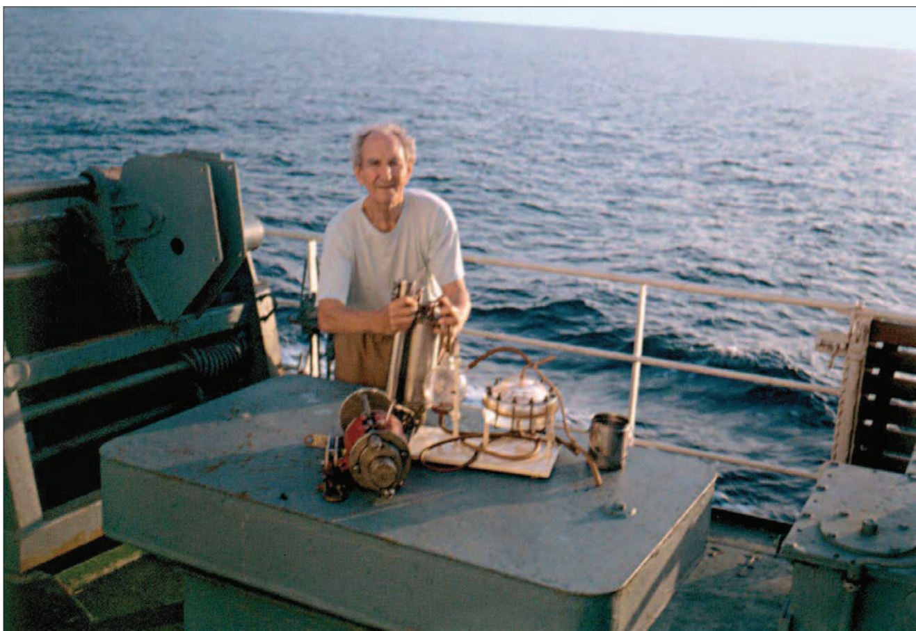
Операция по выделению газовой фазы из морской воды с помощью дегазационной установки.
