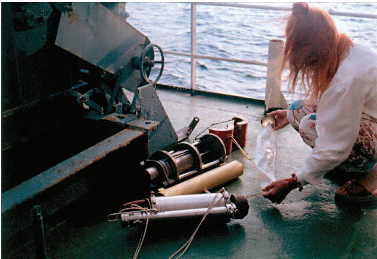
Пробоотборники требуют ухода – стерильной чистоты внутренней полости.
