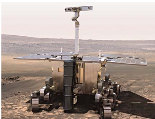
Рис. 5.32. Марсоход по проекту EхoMars (ESA/Роскосмос), предназначенный для биохимического исследования подповерхностного грунта.
