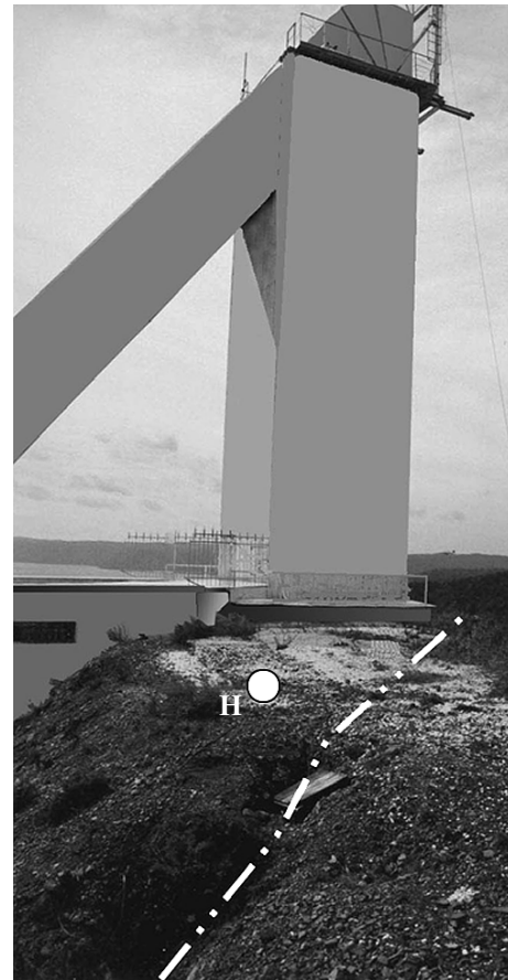
Рис. 6. Участок Ангарского разлома, на котором осуществлялись натурные эксперименты Штрихпунктир — линия разлома; точка Н — место закачки воды
