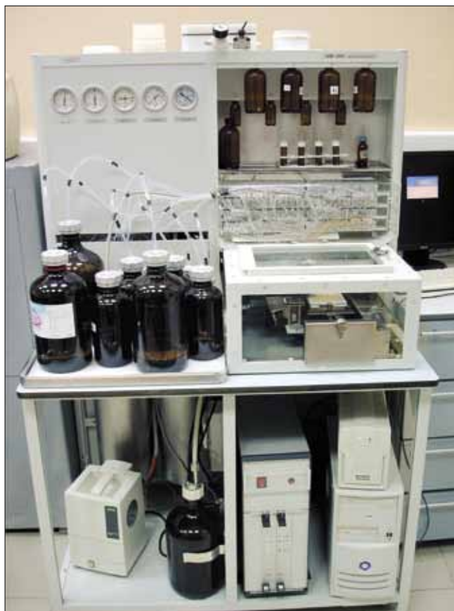
Планшетный ДНК-синтезатор позволяет получать 96 олигонуклеотидов за один цикл синтеза.
