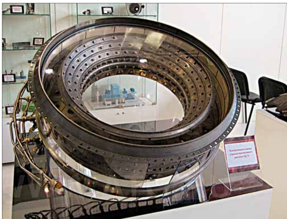
Полноразмерная камера сгорания будущего двигателя ПД-14 (ОАО «Авиадвигатель») для пассажирского лайнера МС-21. Фото АТО.ru
