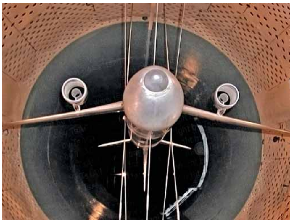
Испытания модели самолета МС-21 в аэродинамической трубе Т-106 на обледенение. Фото пресс-службы ЦАГИ.
