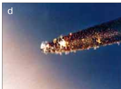
Биовреждения на космической станции: a – обрастание иллюминатора плесневыми грибами, b – рост плесневых грибов на изоляции проводов прибора связи, c,d – биокоррозия иглы детектора дыма.
