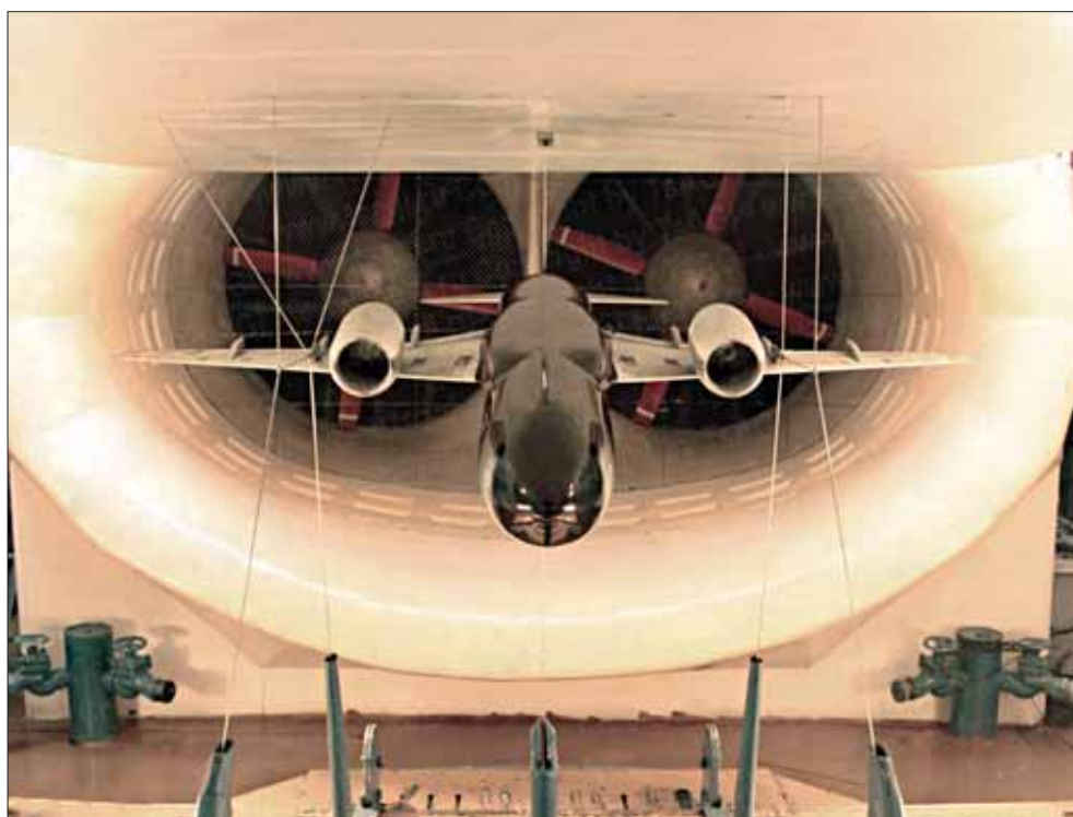
Испытание модели самолета MS-21 в аэродинамической трубе Т-102 в Центральном аэрогидродинамическом институте им. Н.Е. Жуковского (г. Жуковский Московской области). Фото пресс-службы ЦАГИ.
