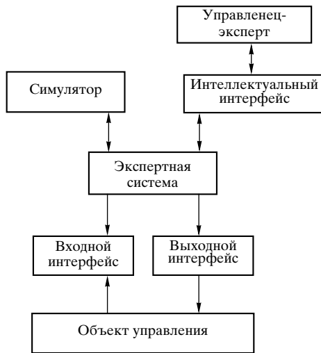
Рис. 3. Концептуальная архитектура интеллектуальной системы логического управления.
